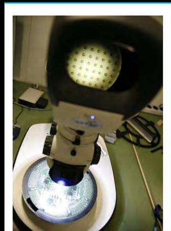
Durch Testen und Überwachen der ICs bereits auf Wafer-Ebene stellt Dialog eine optimale Produktionsausbeute beim Endprodukt, dem Packaged-Chip, sicher.
